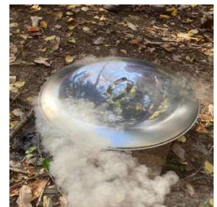
それから、今年度の「ひょうご環境保全連絡会からの助成金」で購入した炭化炉を使った炭作りにもチャレンジ。この炭化炉を使った炭作りはこれまでは燃え尽きてしまっていて失敗していましたが、今回は炭化炉の底に土を敷いてうまく酸欠状態を作れたので無事に炭ができました。火を起こした後に炭化させる木のサイズと投入タイミングを揃えればもう少し上手く炭ができそうです。後日談ですが、「炭団づくり」の先生と知り合いになったので、この炭化炉で炭を作り、さらにその炭を炭団にして持ち帰る体験も計画中ですので楽しみにしてください。
